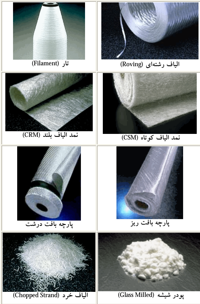
شکل شماره ۹- اشکال گوناگون الیاف شیشه، پر کاربرد ترین الیاف مواد کامپوزیتی
