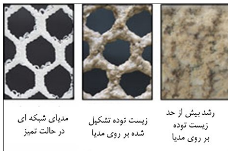
شکل شماره ۷- شمائی از تشکیل بیوفیلم بر روی بستر
