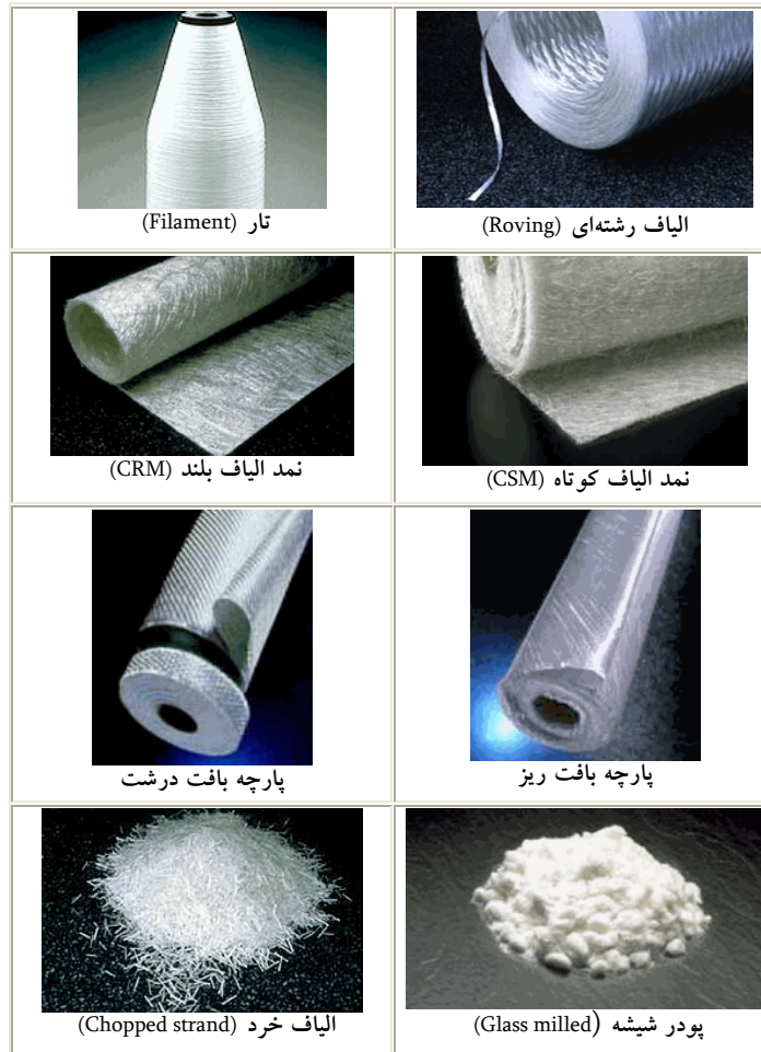
شکل شماره ۴- اشکال گوناگون الیاف شیشه، پرکاربردترین الیاف مواد کامپوزیتی
