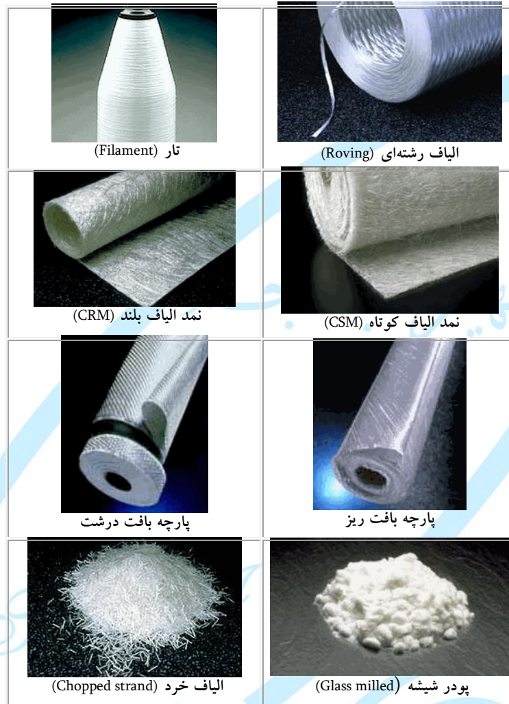
شکل شماره ۲- اشکال گوناگون الیاف شیشه، پرکاربردترین الیاف مواد کامپوزیتی
